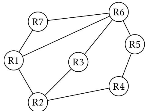
**EXERCICE 4 :** On représente ci-dessous un réseau dans lequel R1, R2, R3, R4, R5 et R6 sont des routeurs. Le réseau local L1 est relié au routeur R1 et le réseau local L2 au routeur R6.
